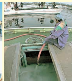
漁港に設置した装置でつくった滅菌シャーベットアスを魚倉に入れる。
